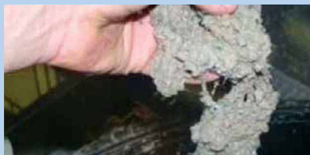
Рисунок 7: Волокнистые загрязнения (жгуты) могут накапливаться на лопастях ротора и образовывать более крупные сгустки, которые могут застрять между ситом и ротором.
