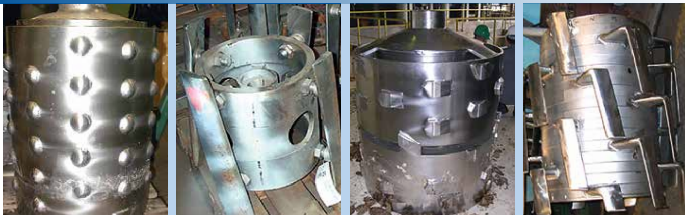
Рисунок 1: С момента внедрения напорных сортировок в 1960-х годах использовались различные конструкции ротора, в том числе: а) кулачковые роторы (1960-е годы), б) лопастные роторы по типу «шпилька-и-гайка» (1970-е годы), в) «модифицированные кулачковые» роторы (1990-е годы) и г) консольные лопастные роторы (2000 годы).
